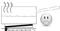
Ferromagnetisches Element wurde schlecht eingebaut
